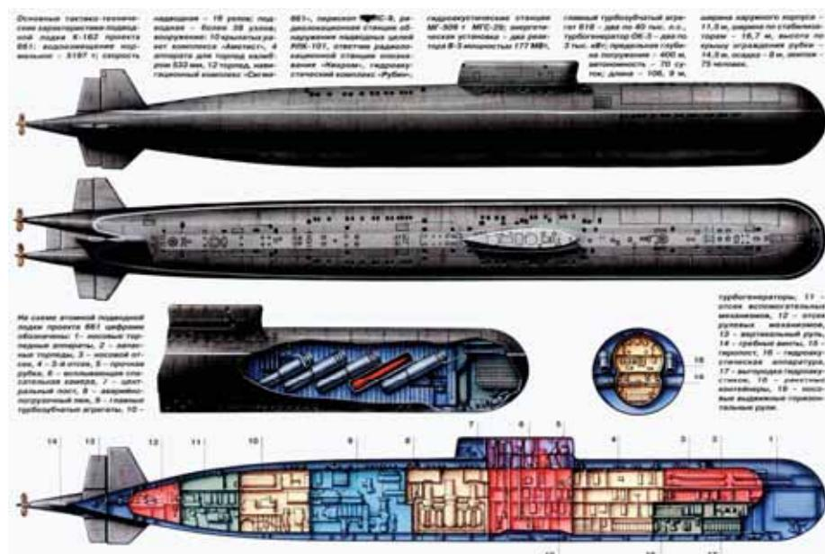
10 контейнеров с ПКР – побортно с постоянным углом возвышения в между бортном пространстве в районе первых трёх отсеков, используя разницу в диаметрах "восьмерки" и остального цилиндрическо-
