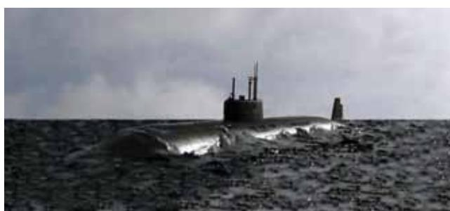
К-162 (с 1978 г. – К-222) — советская атомная подводная лодка второго поколения, вооружённая крылатыми ракетами П-70 «Аметист», единственный корабль, построенный по проекту 661 «Анчар». Самая быстрая в мире подводная лодка, достигавшая в подводном положении скорости свыше 80 км/ч (42 узла). За дороговизну постройки лодку прозвали «Золотая рыбка».\*
