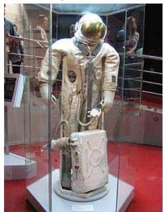
Система жизнеобеспечения (СЖО) нового скафандра «Ястреб» находилась в металлическом контейнере (ранце), который, для облегчения прохода космонавта через узкий люк диаметром 600 мм корабля «Союз», монтировался спереди на ногах. СЖО скафандра Ястреб была регенерационного типа. Электропитание, связь и телеметрия производились через фал с бортом корабля.
