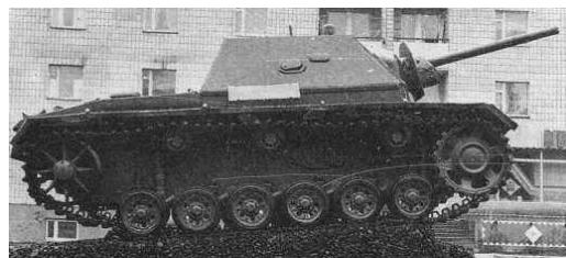
Рубка имела форму усеченной пирамиды с рациональными углами наклона броневых листов и крепилась к корпусу машины с помощью болтов. Стык броневой рубки и корпуса машины был усилен наварными броневыми накладками толщиной 10-мм.
