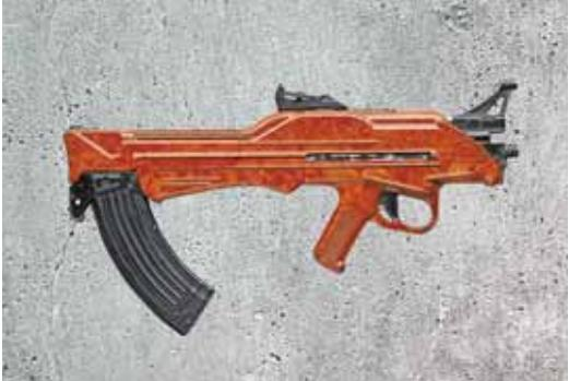
Автомат конструкции Германа Коробова ТКБ-022ПМ. Огневые испытания подтвердили его высокую надежность. При автоматической стрельбе из неустойчивого положения автомат показал кучность стрельбы в три раза выше, чем АКМ. Масса автомата без магазина составляла всего 2 кг при длине оружия 525 мм. Отличался широким применением пластмассы
