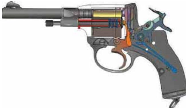
Вращение барабана и подача его вперёд производились особой деталью – собачкой – шарнирно связанный со спусковым крючком. В заднее положение барабан возвращался
