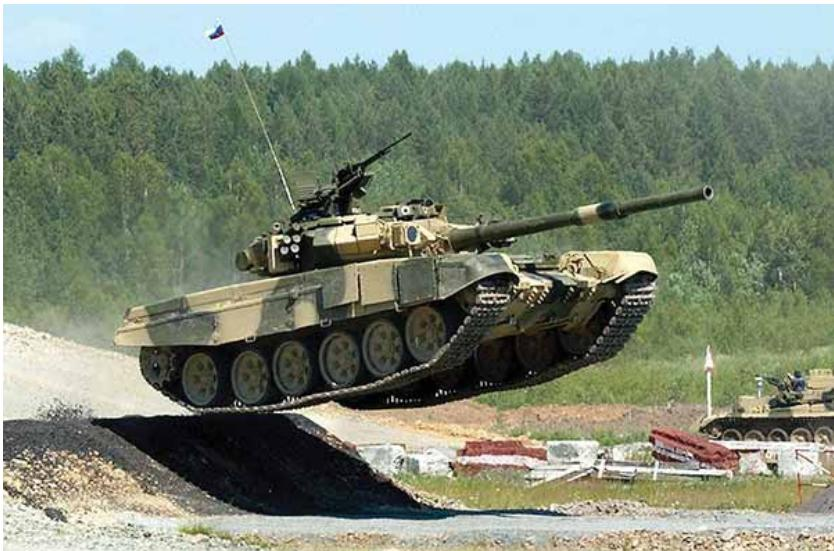
Единственное, в чем проигрывает Т-90, так это в силовой установке. С другой стороны, как на это посмотреть. На стандартный для ВС РФ танк Т-90 установлен дизельный двигатель мощностью 840 л.с. На всех танках НАТО двигатели мощностью около 1500 л.с. Ну и что? По критерию масса танка и его мощность двигателя российские машины не очень-то и уступают западным.
