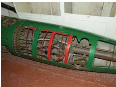
Двигатель парогазовой торпеды.
