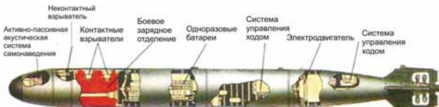
Наиболее распространённый калибр морских торпед (диаметр корпуса в наиболее широкой его части) — 533 мм (21 дюйм) (также известны образцы от 254 до 660 мм). Средняя длина (для универсальных торпед) — около 7 м, масса (для универсальных торпед) — около 2 т, заряд взрывчатого вещества (для универсальных торпед) — 200—400 кг.
