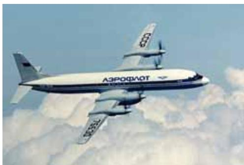
Самолёт Ил-18 – четырёхмоторный турбовинтовой лайнер для авиалиний средней протяжённости, созданный под непосредственным руководством С.В. Ильюшина. Этот самолёт стал самым массовым в своём классе первого поколения пассажирских лайнеров с газотурбинными двигателями, воплотив в себе все основные
