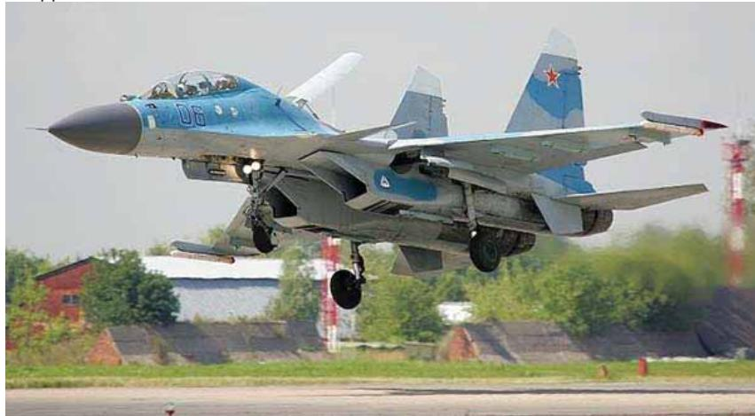
Трапецевидное среднерасположенное крыло выполнено трёхлонжеронным и имеет кессонную конструкцию. Его механизация состоит из отклоняемых флаперонов с площадью 4,9 м<sup>2</sup> с функциями элеронов и закрылков, а также отклоняемых аддативных двухсекционных носков с площадью 4,6 м<sup>2</sup>. Отклонения носков и выпуск флаперонов проводится при режимах взлёт-посадка, либо при маневрировании, когда приборная скорость до 860 км/ч. Отделляемые консоли крыла имеют угол стреловидности 42°.
