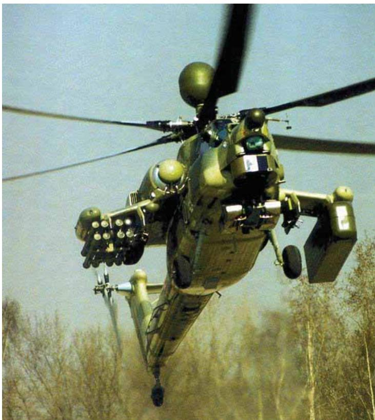
Особенности конструкции обеспечивают высокую живучесть вертолёта. Выживаемость экипажа при аварийных посадках с вертикальными скоростями до 12 м/сек обеспечивается применением системы пассивной защиты с энергопоглощающими элементами конструкции (шасси, кресла, элементы фюзеляжа).
