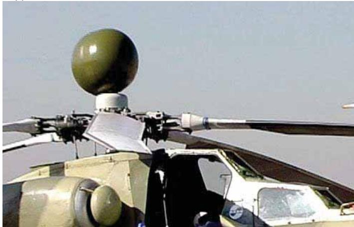
Боевой вертолёт круглосуточного действия Ми-28НЭ представляет собой двухместный (лётчик и штурман-оператор) вертолёт классической одновинтовой схемы с пятилопастным несущим винтом и X-образным рулевым винтом, управляемым стабилизатором, колёсным неубираемым шасси с хвостовой опорой. Крыло служит для подвески вооружения
