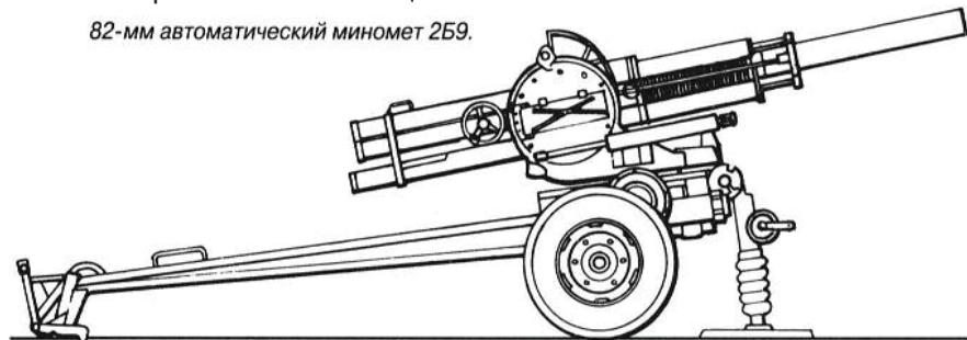
Первоначально миномёт 2Б9 «Василёк» имел водяное охлаждение ствола, однако через несколько лет конструкторы пришли к выводу, что воздушное охлаждение будет более удобным. Кожух, в который помещался ствол и заливалась вода, был снят, стенки ствола сделали толще и снабдили его поверхность ребрами, выполняющими роль радиатора.
