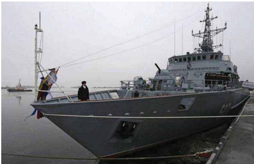
Технология выдувного кораблестроения в российском флоте применяется впервые. Она позволяет при увеличении прочности корабля снизить его массу, увеличить срок службы и значительно уменьшить магнитное поле, что обеспечивает дополнительную безопасность при тралении мин.
