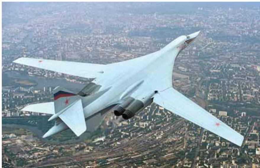
Ту-160 (заводское обозначение: «изделие 70», обозначение разработчика — «К», по кодификации НАТО: Blackjack — «Блэқджек») — сверхзвуковой стратегический бомбардировщик-ракетоносец с крылом изменяемой стреловидности, разработанный в ОКБ Туполева в 1970-х годах. Главный конструктор — В.И. Близнюк.
