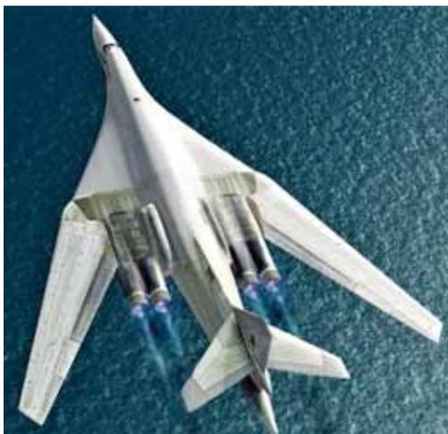
Крыло на самолёте изменяемой стреловидности. Размах крыла при минимальной стреловидности составляет 55,7 м. Поворотный узел и система управления в общем аналогичны Ту-22М, но соответственно пересчитаны и усилены. Поворотная часть крыла переставляется по передней кромке с 20 до 65 градусов. Крыло кессонной конструкции, выполнено в основном из алюминиевых сплавов. По передней кромке установлены четырёхсекционные
