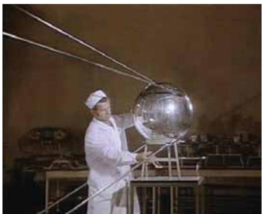
Внутри герметичного корпуса были размещены: блок электрохимических источников; радиопередающее устройство; вентилятор; термореле и воздуховод системы терморегулирования; коммутирующее устройство бортовой электроавтоматики; датчики температуры и давления; бортовая кабельная сеть. Масса: 83,6 кг.
