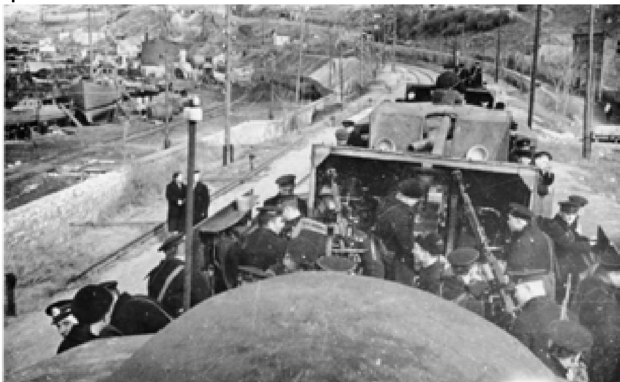
Севастопольский бронепоезд «Железняков» в боевом рейде. На фото видны корабельные башенные установки 34-К с орудиями калибром 76,2-мм и 12,7-мм крупнокалиберные пулеметы ДШК (Дегтярева-Шпагина крупнокалиберный).
