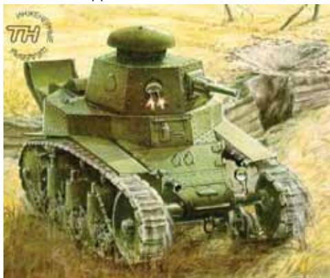
На рисунке изображена ранняя версия танка МС-1 с пулемётами Фёдорова. Позже их сменят одним пулемётом ДТ калибра 7,62 мм. Возимый машиной боезапас уменьшится на 25 %. Уменьшится и плотность пулемётного огня: в шаровой установке вместо двух стволов впредь стоял один.
