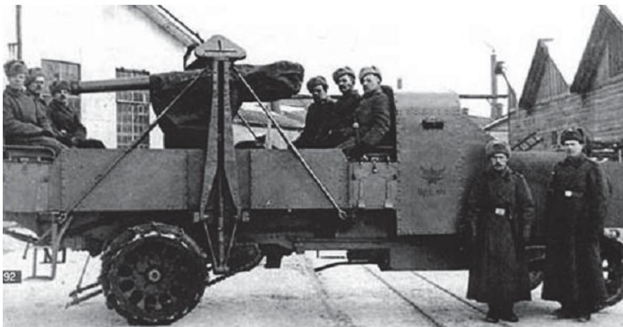
Бронированный грузовик Руссо-Балт Т с 76 мм пушкой Лендера. Поступили в войска в марте 1915, первое использование – июль 1915. Боевой вес – 4,3 т, двигатель – 65 л/с, скорость – 20 км/ч.
